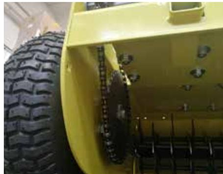
**Système différentiel:** obtenu avec des pignons à roue libre et entraînement à chaîne
