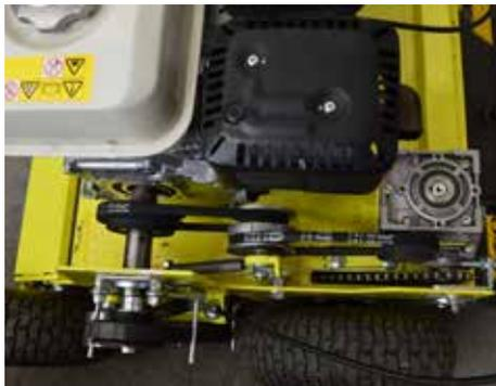
**Régulateur de la vitesse:** obtenue avec une poulie à diamètre variable. Vitesse variable de 0 à 4,5 Km/h.
