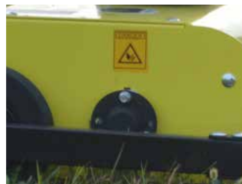
Le système de coupe est soutenu par deux supports et par deux roulements à bille de haute qualité.
