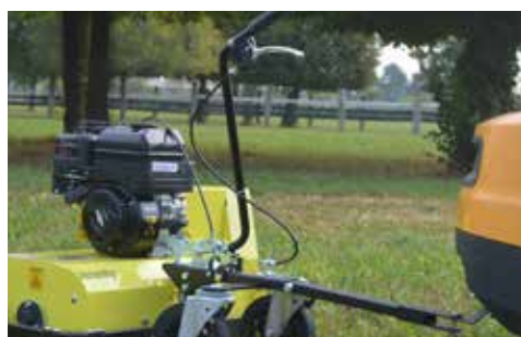
Poignée de soulèvement à actionnement automatique du système de coupe.
