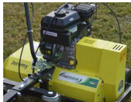
Position centrale du moteur pour un équilibre optimal des poids.
