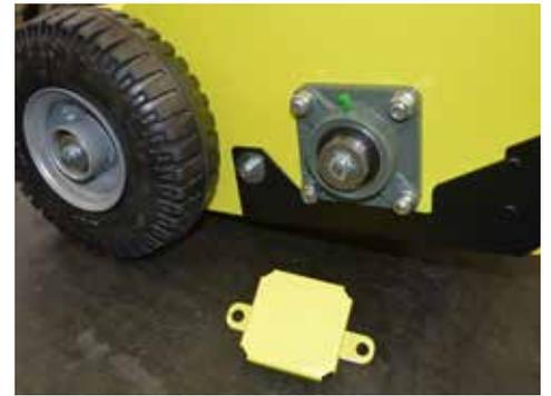
**Le système de coupe** est soutenu par deux supports en fonte et par deux roulements à bille de haute qualité. Le graisseur est facile à atteindre durant la maintenance.
