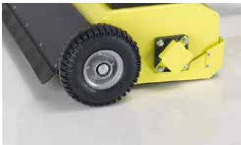
Ruote in gomma morbida che non danneggia l'erba, e semipiene che non si sgonfiano, né si forano. Hanno cuscinetti a sfera e sono montate su un asse di 20 mm di diametro
