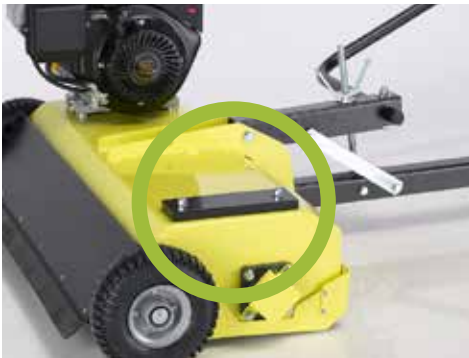
Zavorra di bilanciamento: per bilanciare il peso del motore posto su un lato della macchina, sul lato opposto è presente una zavorra (diversa a seconda del tipo di motore scelto)
