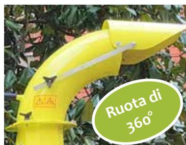
**Curva di scarico regolabile:** La curva di scarico del cippatore Zakandra è caratterizzata dalla possibilità di essere ruotata di 360° permettendo così di direzionare il getto del tritato senza dover muovere il corpo della macchina. La curva di scarico raggiunge un'altezza da terra di cm 192.
