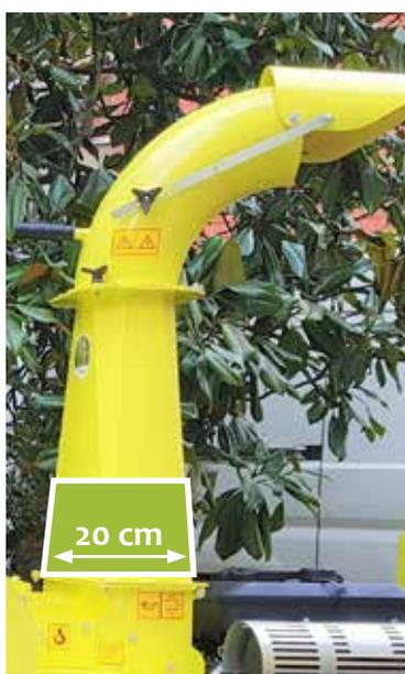
**Sistema antintasamento:** Il cippatore Zakandra presenta un sistema di scarico di notevoli dimensioni che si mantiene ampio per tutta la estensione, evitando strozzature che blocchino il materiale in uscita in un collo di bottiglia. Grazie anche al volume d'aria generato dalla rotazione del sistema di taglio, Zenith è in grado di scaricare agevolmente quasi tutti i tipi di materiale tritato anche se particolarmente umido o foglioso, minimizzando gli intasamenti e i fermi macchina.
