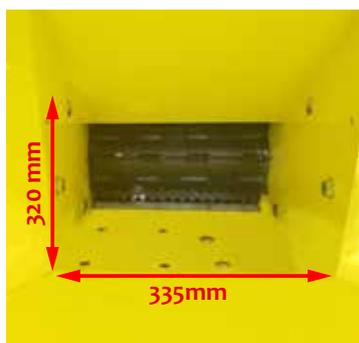
**Tramoggia carico inferiore**: la bocca di carico si mantiene ampia anche nel punto di taglio, questo fa sì che la macchina sia in grado di triturare materiale particolarmente frondoso, come ad esempio quello delle potature d'ulivo, evitando intasamenti e permettendo la triturazione di notevoli quantità di materiale ad ogni carico con una considerevole riduzione dei tempi di lavoro.
