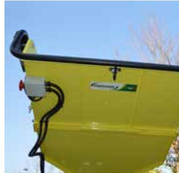
Solo per modelli con tramoggia "TL1", **regolazione della velocità** ed Inversione del rullo di alimentazione tramite azionamenti e comandi elettrici.
