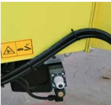
Solo per modelli con tramoggia "TL", **Regolazione velocità del rullo di alimentazione.** la velocità del rullo di alimentazione viene regolata agendo sulla manopola del regolatore de flusso.
