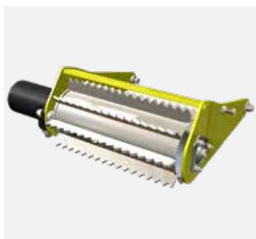
Inserimento facilitato della potatura con **rullo idraulico**: si tratta di un rullo dentato in acciaio del diametro di 190 mm posto alla fine della tramoggia di carico e subito prima del sistema di taglio. La sua funzione è quella di trascinare il materiale da triturare all'interno del sistema di taglio (larghezza rullo 332 mm).
