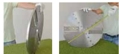
Dispositivo di taglio : diametro 60 cm - spessore 2 cm
